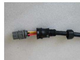
Рисунок 4.16 – Подсоединение кабеля к терминалу
